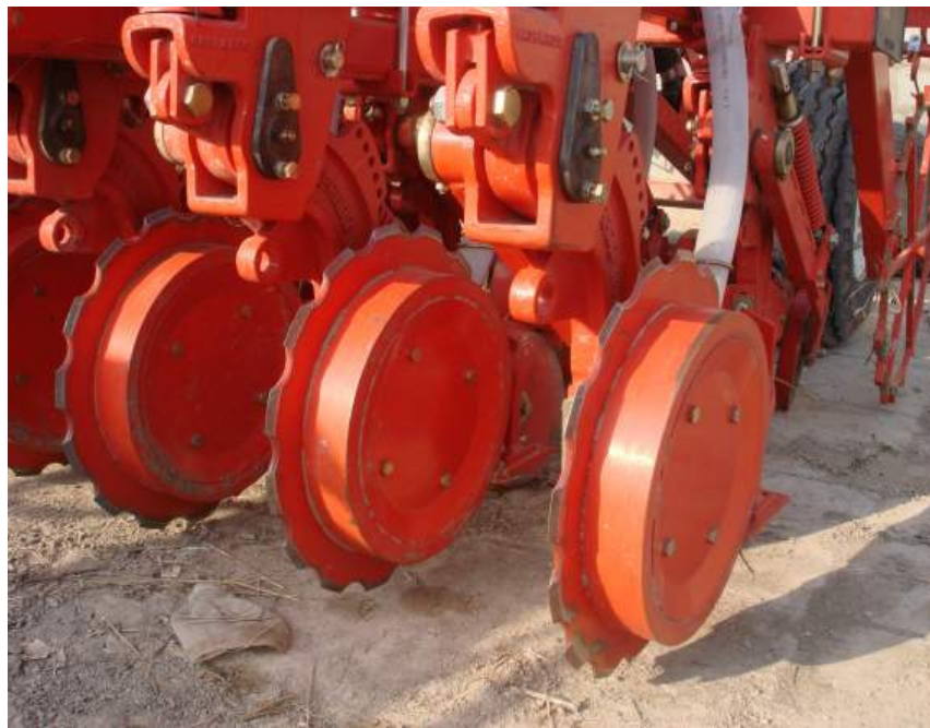
شکل ۴- بذرکار No-Till (با شیار بازکن های بشقابی کنگره دار)
